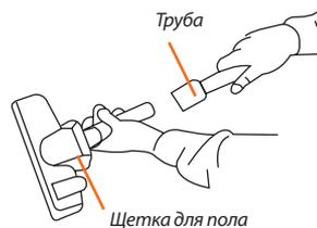
3. Соедините удлинительную трубу с рукояткой, удлинительные трубы между собой, и трубу со щеткой для пола, как показано на рисунке.
