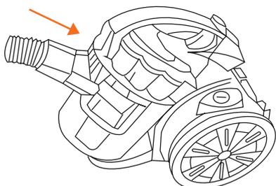
1. Вставьте конец шланга во всасывающее отверстие пылесоса и поверните против часовой стрелки на 90 градусов до щелчка.
