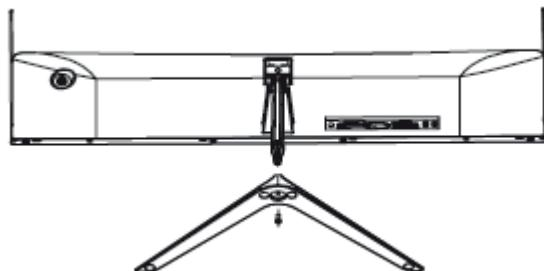
2. Положите монитор на ткань ЖК-панелью вниз, чтобы предотвратить повреждение ЖК-панели. Прикрепите основание подставки к задней части монитора, затянув винты.
