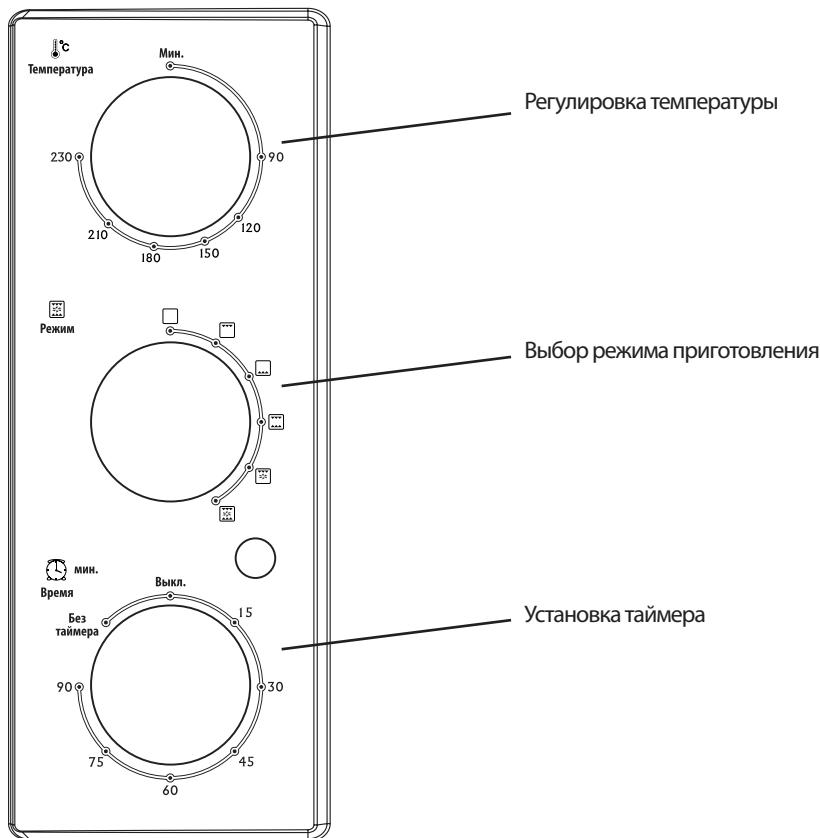
На панели управления расположены регулятор температуры, переключатель режимов работы печи и ручка таймера.
