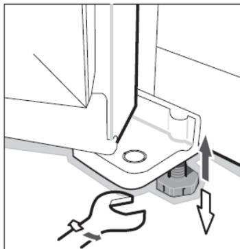
В транспортировочном положении ножка/ножки (в зависимости от модели) завернуты до упора. При установке отрегулируйте высоту ножек для выравнивания и устойчивого положения холодильника. Это возможно сделать с помощью ключа или вручную.
