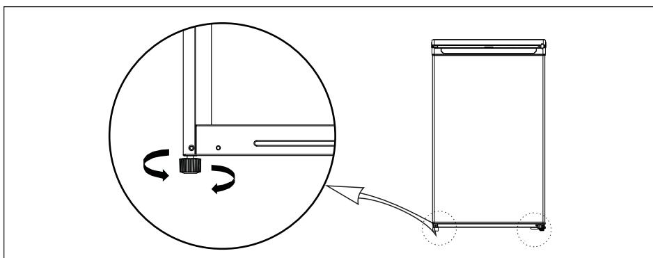
Перед регулировкой убедитесь в том, что морозильник не подключен к сети питания. Откорректируйте уровень морозильника с помощью регулировочных ножек: - чтобы поднять морозильник, поворачивайте ножку по часовой стрелке (при взгляде сверху), чтобы опустить морозильник, поворачивайте ножку против часовой стрелки. Перед началом использования убедитесь, что все ножки морозильника устойчиво опираются на пол.
