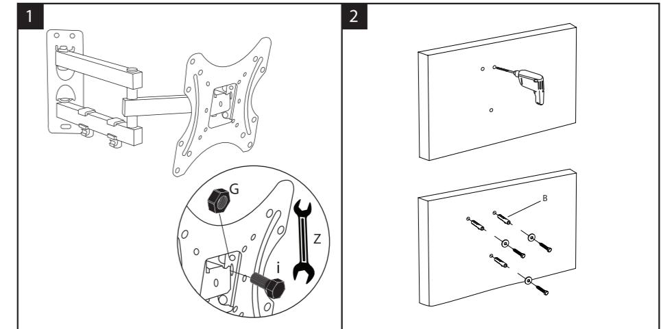
1. Прикрепите кронштейн к монтажной пластине с помощью гайки (G), болта (I) и гаечного ключа (Z).
