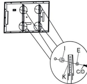
ШАГ 3 Установка на настенную пластину
