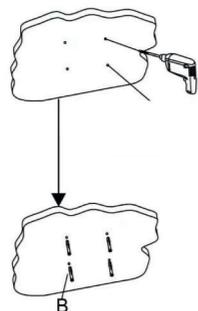
ШАГ 1Б Крепление на деревянную стену
